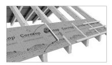
3. Clave los contralistones de tal manera que queden cubiertos los lugares por donde las grapas o el papel de fieltro penetran la membrana. Para sellar la membrana se recomienda (en el caso de cubiertas con una inclinación inferior a 20° es necesario) que antes de instalar el contralistón se recomiende pegar una cinta selladora (p. ej. Corotop Pur) en el lado de presión. la membrana.
